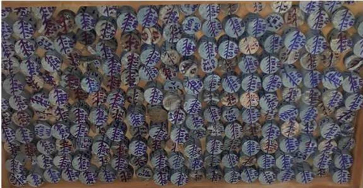
Fig. 4.4. Conjunto de espécimes padrão preparados para as medidas de magnetização e outros procedimentos.
