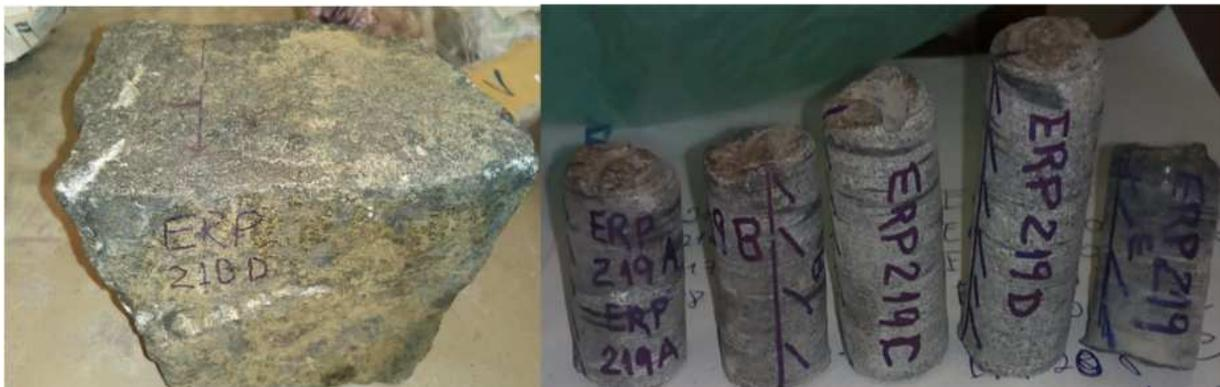
Figure 4.3. Foto de bloco de mão já orientado e cilindros extraídos em campo com suas marcas fiduciais.
