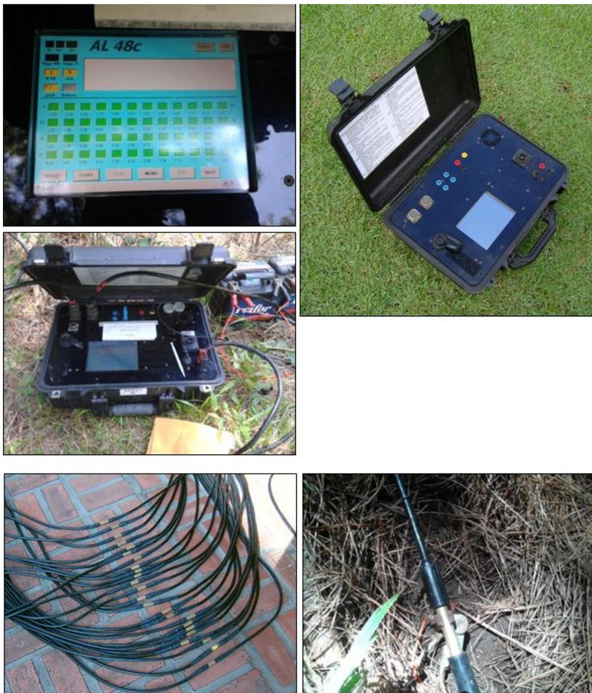
Figura 12 - Resistivímetro EEG AL48, cabos multipolares e eletrodo.
