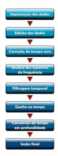
Figura 4. 12 – Fluxograma das etapas de processamento GPR.
