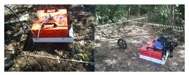
Figura 4.7 - Equipamento GPR utilizado
