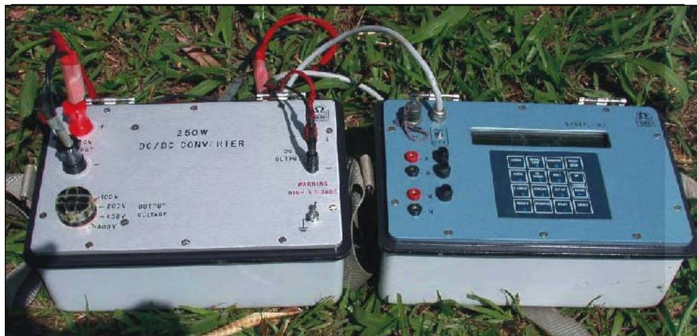
Figura 8 - Equipamento para ensaios de resistividade *Iris Syscal R2*.
