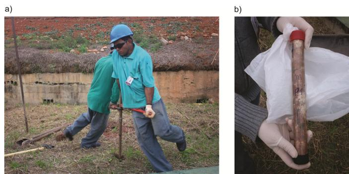
**Figura 3.5:** a) Perfuração do solo com o trado e b) amostra coletada com o *liner*.
