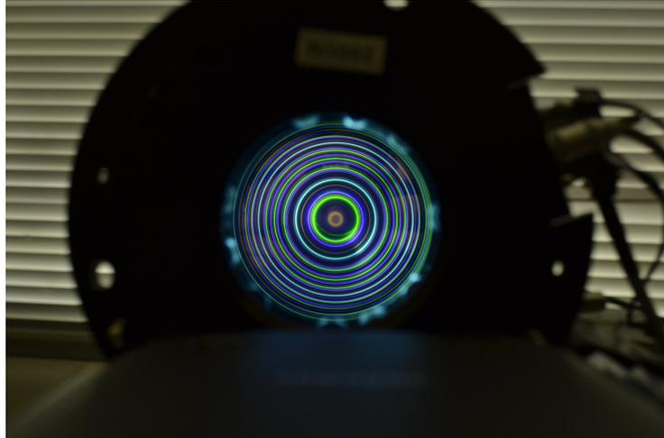
Figura 3.13: Fabry-Perot instalado sobre uma mesa e iluminado por uma lâmpada de mercúrio.
