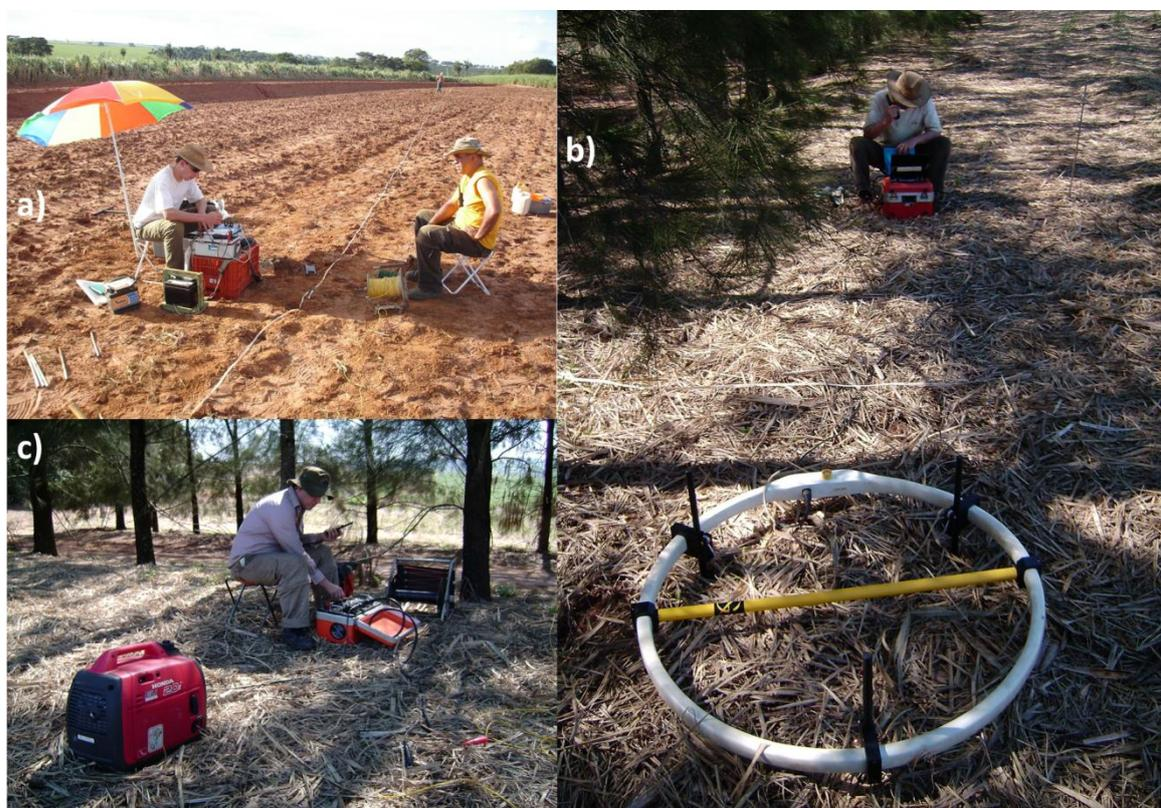
Figura 2: Aquisição de dados em Bebedouro-SP. “a” o equipamento Syscal R2 (Iris Instruments), “b” o equipamento PROTEM e bobina 1D e “c” o equipamento Geonics TEM57-MK2.
