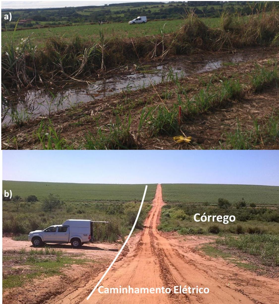
Figura 9: Aquisição de dados em Ibirá-SP. “a” curva de nível com água da chuva acumulada ao longo da linha de aquisição e “b” linha de caminhamento elétrico cruzando o córrego presente na área.
