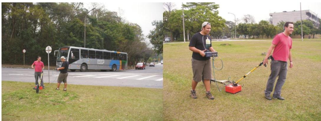
**Figura 7.41** – Local da aquisição com antena de 400 MHz na rotatória da Biologia no Campus USP da Capital.
