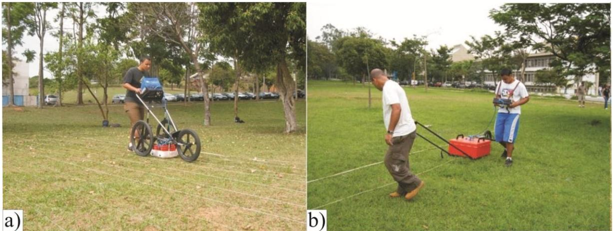
**Figura 5.1** - Aquisição de dados no SCGR. a) Antena de 400 MHz. b) Antena de 200 MHz.
