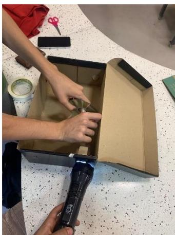
Figura 4 - Construção do espectroscópio<sup>10</sup>.
