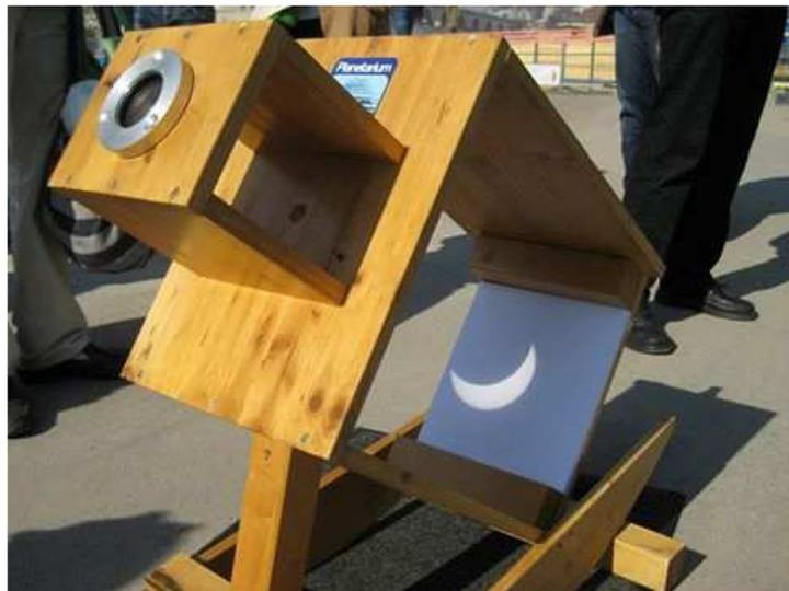
Fig.3.8 – Imagem de um eclipse do Sol projetada em uma cartolina com o uso de um equipamento de projeção produzido no Planetário de Stuttgart (Alemanha).
