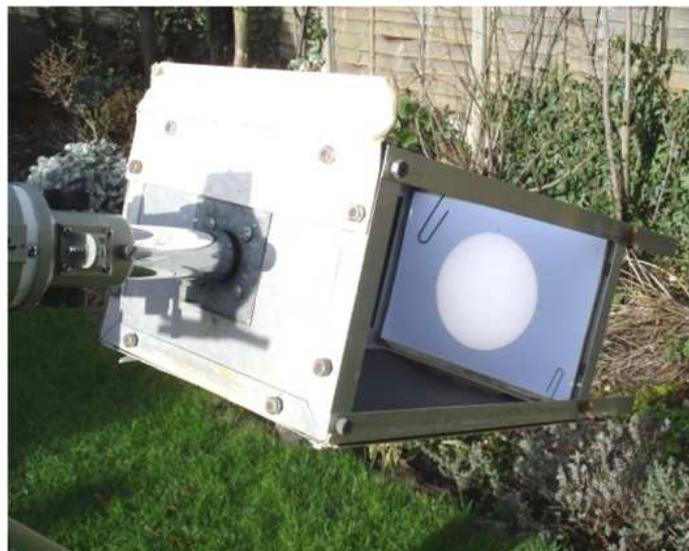
Fig. 3.5 – A imagem solar ampliada e projetada em um anteparo, com o uso de uma luneta (telescópio refrator) de pequeno porte.
