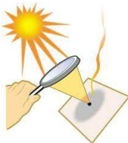
Fig. 3.1 – Concentrando a luz do Sol em uma folha de papel com uma lente convergente. Figura extraída de <https://cienciasnoseculoxxi.wordpress.com/tag/lentes-convergentes/>
